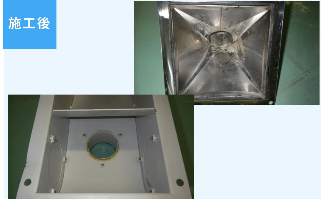
工場で欠かせない搬送装置の一つが昇降機です。精米機直後や無洗米加工直後はもっとも糠などが付着しやすい箇所となります。搬送バケットや下部点検口は目につきやすく、清掃も可能ですが、上記写真のように上部箇所になると、高所となり、部品を外さなければならため、清掃が困難となることが多いです。箇所を確認し、どのような清掃・施工計画を考えるかが重要となります。
